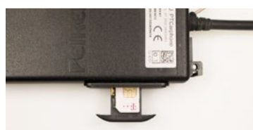
Bild: Offener SIM-Karten-Halter mit SIM-Karte
